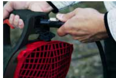
Kabelaansluiting van de 82B20 om de accu aan te sluiten.
